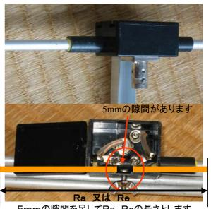
5mmの隙間を足してRa、Reの長さとします。
