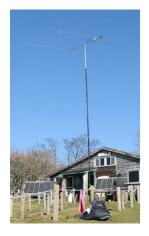
この「2エレ位相給電アンテナ」は、マッチング 方法に、2本のエレメントから給電点までの距 離でマッチングをとる方式を採用しています。 その結果、ショートバーなどのパーツを必要と しませんので組み立てやすさと軽量化に貢献 するだけでなく、3~4エレ八木の性能に匹敵 するとも言われています。
